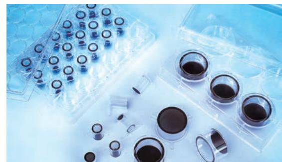
ポリイミド多孔質膜細胞培養基材
